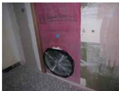
Test d'étanchéité à l'air d'un bâtiment
